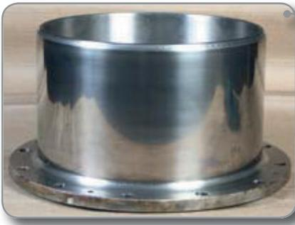
Liner recuperado zona exterior de alojamiento de sello manteniendo medidas estandar. Material aplicado aleacion de cromo con sistema de metalizado en frio Arc Thermal Spray
