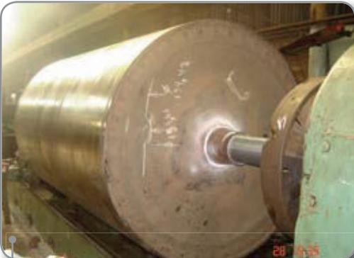
Recuperación de eje muñon en zona de alojamiento de rodamiento a polin utilizado en celulosas y papeleras; material aplicado Aleación de Cromo tipo 420, con dureza 40 - 43 HRc.
