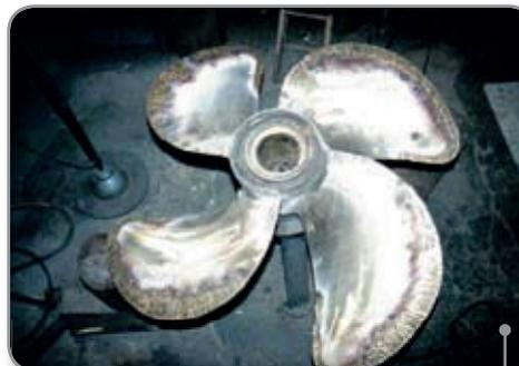
Helice en proceso de recuperacion en todo su borde de ataque aumentando diametro y espesor en aleacion Br-Mn;Br-AL-Ni; Br-Nab ; Inox al cromo y aleaciones de AL; toma de paso y balanceo.
