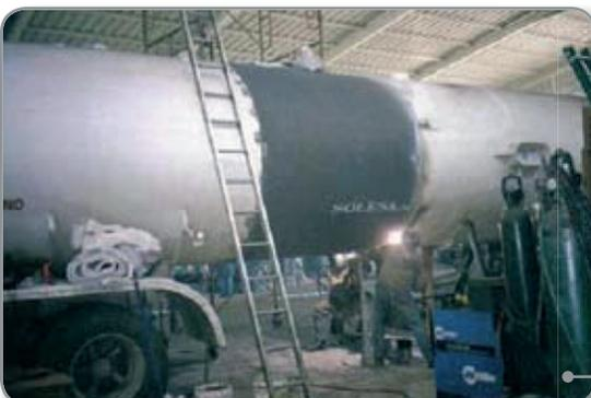
Ampliación de capacidad de estanque para el transporte de gas, en acero especial SAE 517, de espesor 25 mm; sometido a pruebas de RX, alivio de tensiones y pruebas hidroestática.
