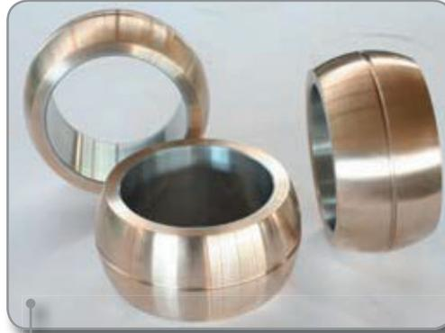
Fabricacion de rotulas en bronce con aplicacion en su zona interior de aleacion de babitt (metal blanco) mediante metalizado en Frio Arc Thermal Spray , especial friccion. Diferentes diametros, anchos y espesores.
