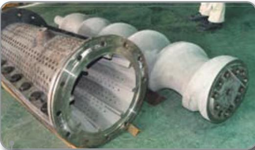
Eje tornillo de bomba deshidratadora, recuperada mediante metalizado en Frío HP-HVOF JP 5000 con aporte de Wc- Co, resistente al impacto y erosión
