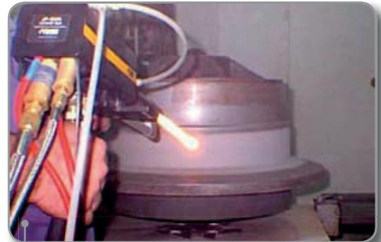
Rodillo o bloque para trefilado de alambre recuperado con sist. HP-HVOF JP 5000, aporte Wc-Co, resistente al desgaste.
