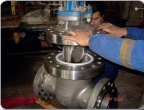
Inspección y recuperación de ajuste y claro; Prueba hidráulica de alta presión a válvula de cuña.
