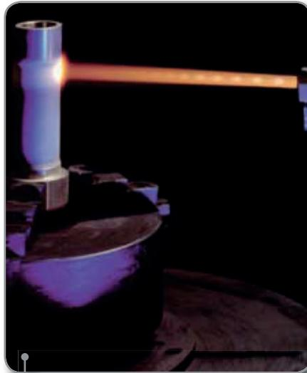
Aplicación de carburo de cobalto mediante HVOF a eje bocina utilizado en el proceso de fabricación de cemento, celulosa, acero, entre otras.
