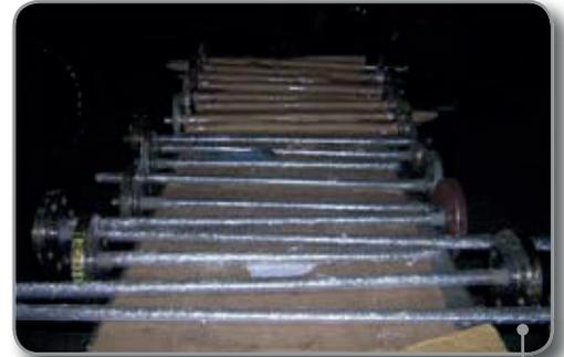
Carcasas protectoras termocuplas para hornos de altas temperaturas, material base Acero Inoxidable con aplicación de recubrimiento metálico Carburo de Tungsteno, sistema HP-HVOF JP 5000, utilizadas en la ind. de acero, petróleo, papel, entre otras.
