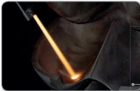
Recuperación de turbina o rueda PELTON, mediante metalizado en frío HP-HVOF JP 5000 con aporte de Wc especial.
