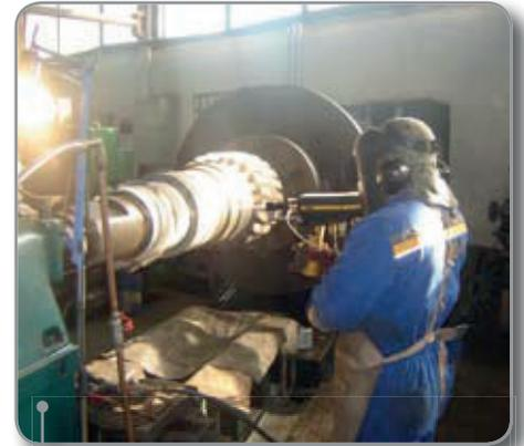
Eje engranaje helicoidal rodillo conductor en proceso de recuperación equipo de alta tecnología HP-HVOF JP 5000, aplicación de Carburo de Tungsteno.
