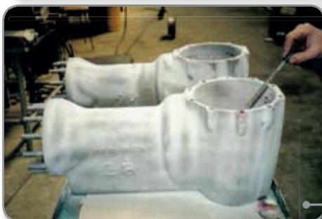
Carcaza Truster, recuperación de alojamiento de rodamiento en acero fundido tipo austenitico. Previo Ensayos No Destructivos (END), a traves de tintas penetrantes.
