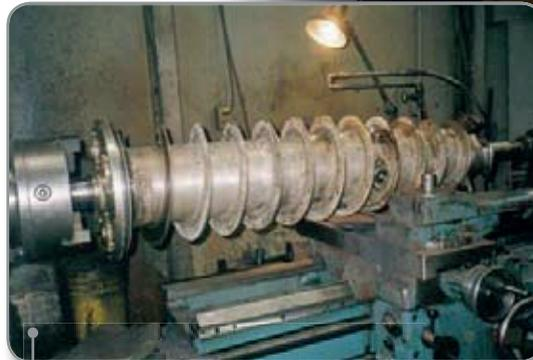
Tornillo decanter con aplicación de recubrimiento ultra duro en sus alaves, para la diferentes industrias, con balanceo dinámico de RPM.
