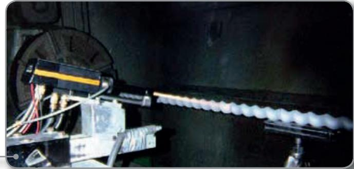
Rodillo para la fabricación de hielo escama, recuperado mediante metalizado en frío HP-HVOF JP 5000, con aplicación de cromo o duro aluminio en un material base de Acero.
