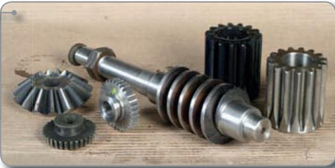
Fabricacion de eje piñon con estrias interiores en acero alta resistencia con tratamiento termico de dureza con 55 - 58 HRC. Para rodamiento tornamesa de grua.
