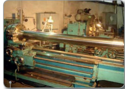
Vastago biela recuperado su superficie con aleación de cromo tipo 420, mediante sistema de metalizado en frío Arc Thermal Spray; dureza 40 - 43 HRc. Para motores de embarcaciones de gran envergadura.
