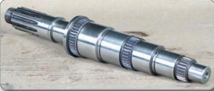
Fabricacion de eje transmision con estrias y engranajes en diferentes sectores y diametros. Zona de rodamiento polines con aplicaci3n de carburo de tungsteno mediante metalizado en frio HP HVOF JP 5000
