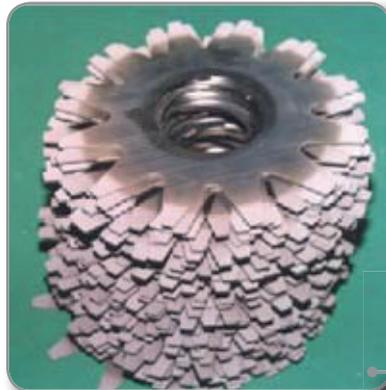
Hojas trituradoras o mezcladoras, recuperadas mediante metalizado en frío HP HVOF JP 5000, con aporte de Wc-Co. Resistente al impacto y erosión por roce
