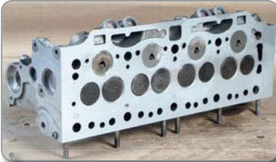
Culata de motor de aluminio y hierro fundido de todo tipo de motores; recuperacion de grietas, fab. asientos de valvulas, prueba hidraulica
