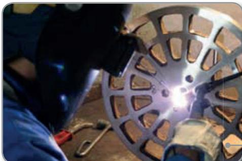
Aplicación de Cobalto a cuchillo triturador de máquina chancadora, superficie de corte. Dureza 62-65 HRC.
